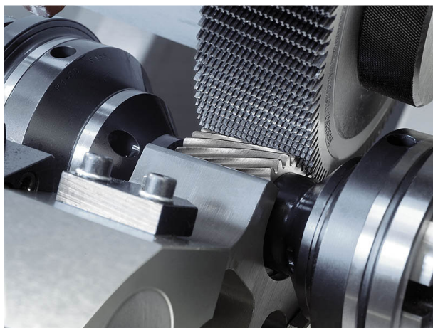
Figura N°1 - Rasatura a tuffo di un ingranaggio con fascia larga su rasatrice Sicmat
